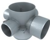
Con tres entradas Ø 55 mm y una salida Ø 75 mm, con dispositivo antiolores extraíble. Su caudal de flujo es de 1,8 l/s.
