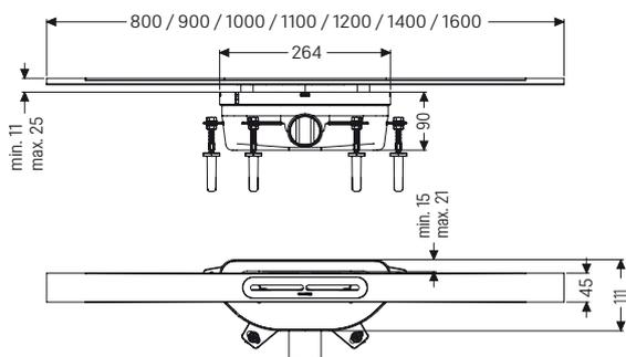
**Dispositivo antiolores con junta hidráulica de 50 mm**
