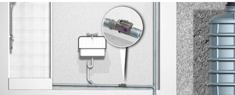
Ø 50 o Ø 75 tubería de desagüe expuesta
