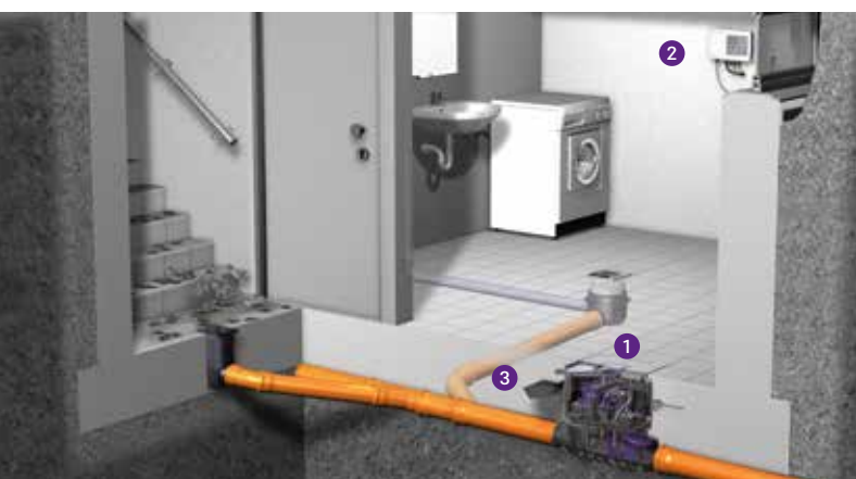
1 Poço de bombagem antirretorno 2 Unidade de controlo 3 Conjunto de juntas de vedação
