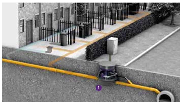
1 Estação elevatória híbrida 2 Tubo de pressão
