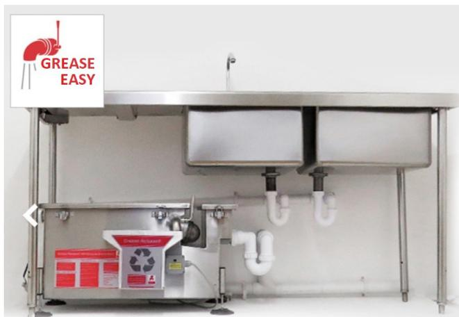
O **GREASE-EASY** é completamente estanque, possui uns pés ajustáveis em altura, um cesto filtrante de inertes e um sistema de aquecimento submersível termostático que permite que as gorduras possam manter-se no estado líquido. O sistema de aquecimento consome apenas um 1Kw e funciona unicamente quando a temperatura da água baixa dos 30°
